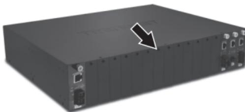
2. Desserrez la vis à molette et enlevez le convertisseur fibre du logement métallique
