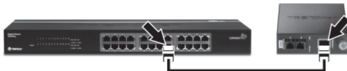
2. Conecte el cable de fibra a los convertidores.
