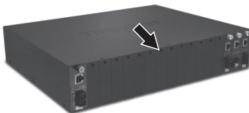
2. Desaperte o parafuso e remova o conversor de fibra da caixa de metal.
