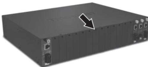
2. Отверните винт с накатной головкой и снимите волоконный преобразователь с металлического корпуса
