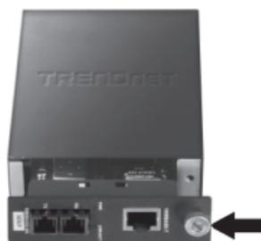
3. Задвиньте преобразователь носителей в имеющееся гнездо и заверните винт с накатной головкой
