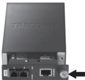
3. Schieben Sie den Medienkonverter in einen freien Steckplatz und ziehen Sie die Schraube wieder an.
