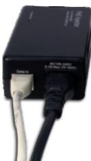
3. Conecte un cable CAT-5 del conmutador al puerto **DATA IN** del TPE-111GI.
