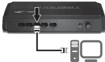
5. Connectez une extrémité d'un câble réseau au port WAN du TW100-BRV214. Branchez l'autre extrémité du câble au port réseau de votre modem.
