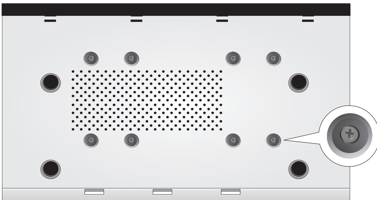
5. Faites glisser le couvercle du TV-NVR216 / TV-NVR216D4 afin de le remettre en place et remettez les vis maintenant le panneau.
