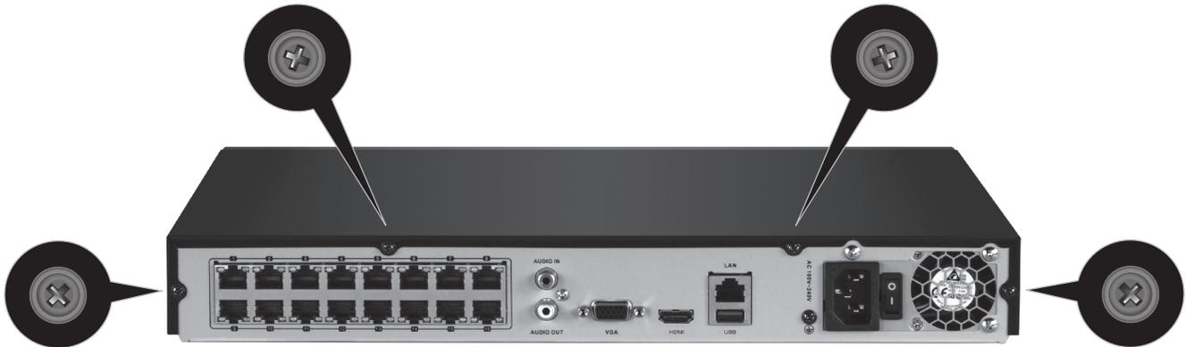
2. Faites glisser le couvercle de l'appareil en tirant le couvercle vers le panneau supérieur.
