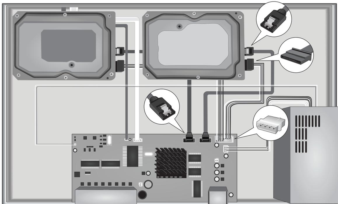
4. Fixez le disque dur à la baies du TV-NVR216 / TV-NVR216D4 en utilisant les 4 vis de fixation, en vissant la partie inférieure du TV-NVR216 / TV-NVR216D4 au boîtier du disque dur.
