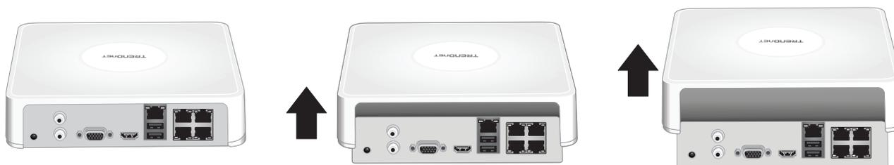
3. Подключите SATA-кабель к жесткому диску (продается отдельно) и к контрольной панели. Разъемы SATA сконструированы так, чтобы предотвратить неправильный монтаж.
