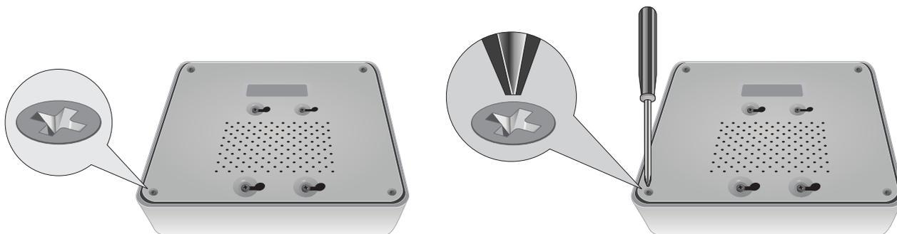
2. Верхняя крышка имеет вертикальные шлицы. С задней стороны устройства аккуратно подвиньте крышку вверх, чтобы отделить ее от нижней панели.
