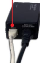
3. Conecte un cable CAT-5e/6 del TV-IP612P al puerto DATA OUT del TPE-111GI.
