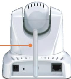
8. Conecte um cabo de rede RJ-45 do Switch/Roteador à porta **Ethernet** da Câmera Internet.
