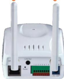
8. Conecte un cable de red RJ-45 del conmutador/enrutador al puerto Ethernet de la Cámara IP.
