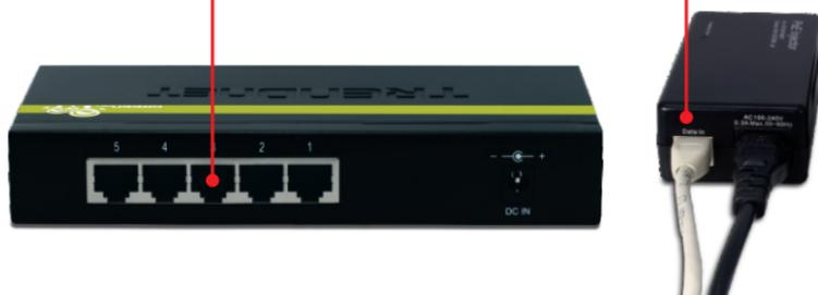
3. Conecte um cabo CAT-5e/6 do TV-IP512P à porta **DATA OUT** do TPE-111GI.
