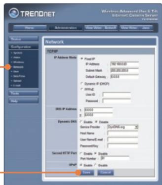
**4. Haga clic en Wireless (Inalámbrico).** Establezca sus opciones de configuración inalámbrica de forma que coincidan con sus configuraciones de red y después haga clic en **Save** (Guardar). (Sólo para TV-IP400W)
