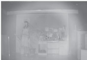
**Figure 4** zeigt den Effekt eines kleinen Pappstücks in 10 cm Entfernung neben der Kamera. Obwohl im Bild nicht sichtbar (die Pappe befindet sich außerhalb des Sichtfelds der Kamera), ist der Effekt erheblich. Um diese Situation zu vermeiden:
