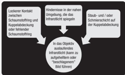
Die stärkste Infrarotspiegelung liegt darin begründet, dass der SCHAUMSTOFFRING nicht fest an die Kamerakuppel angepresst ist. Dies führt zu einem "KREISFÖRMIGEN NEBEL" Effekt (Abbildung 3).
