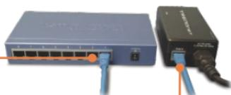
3. Conecte um cabo CAT-5 da porta **LAN** da TV-IP201P à porta **PoE OUT** (Saída PoE) do Injetor.
