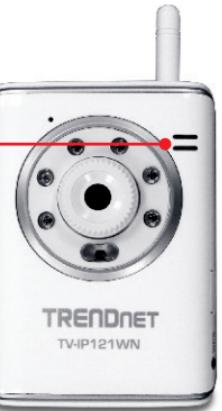
4. Überprüfen Sie, dass die LEDs für die Stromversorgung (amber) und die Verbindung (blinkt grün) aktiv sind.
