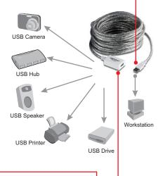
3. Conecte un dispositivo USB periférico al conector USB hembra tipo A del TU2-EX12.
