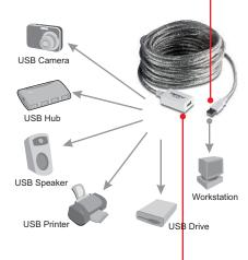
3. Stecken Sie ein USBPeripheriegerät in die USB-Buchse (Typ A) des TU2-EX12.
