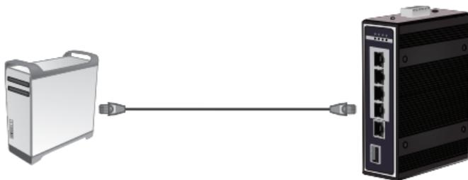
2. Assegnare un indirizzo IP statico all'adattatore di rete del vostro computer nella subnet di 192.168.10.x (e.g. 192.168.10.25) e una subnet mask di.
