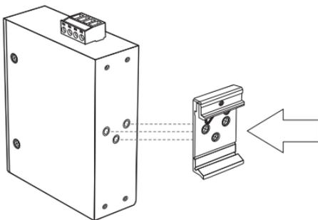
2. Installez l'appareil en face du rail DIN et accrochez le support de fixation au-dessus du rail.
