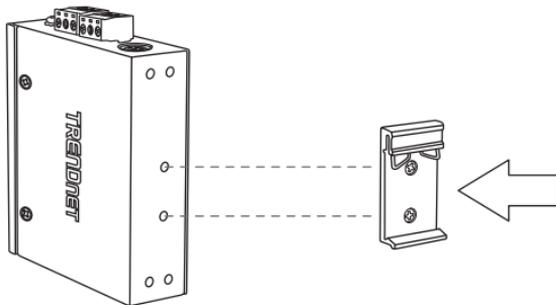
2. Installez le appareil en face du rail DIN et accrochez le support de fixation au-dessus du rail.
