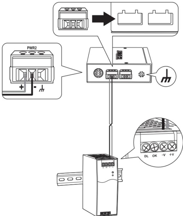
3. Connectez une source et les périphériques réseau au switch. Vérifiez les LED afin de confirmer que les connexions sont établies. Votre installation est terminée.
