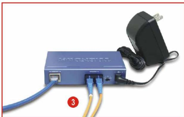
4. Sur le port **100BASE-FX** de l'autre convertisseur de fibre TFC-110MSCE/TFC-110MSTE , branchez la prise TC-15FSC nommée 2 sur le port **RX**, et l'autre prise TC-15FSC sur le port **TX**.
