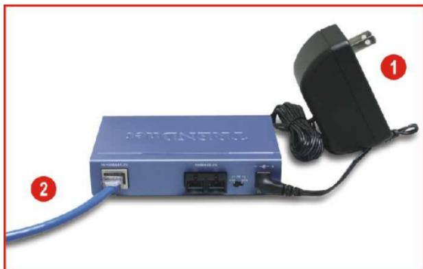
3. Sur le port **100BASE-FX**, branchez la prise TC-15FSC nommée **1** sur le port **TX**, et l'autre prise TC-15FSC sur le port **RX**.
