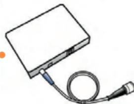
3. Присоедините черную втулку (тип N) кабельной перемычки к грозозащитному разряднику. См. страницу с описанием «Порядок установки грозозащитного разрядника»)
