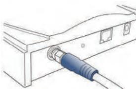
3. Присоедините остающуюся черную втулку (тип N) антенного кабеля к синей втулке (тип N) антенны.
