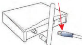
2. Присоедините синюю втулку (Reverse SMA) внутреннего кабеля (TEW-L202/TEW-L208) прямо к устройству Wi-Fi.
