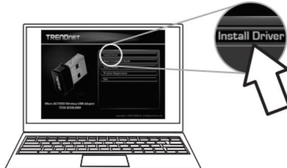
4. Folgen Sie den Anweisungen des InstallShield Assistenten und starten Sie den Computer neu, nachdem die Installation abgeschlossen ist. Nachdem der Computer neu gestartet wurde, stecken Sie den TEW-808UBM in einen beliebigen USB-Port an Ihrem PC ein.
