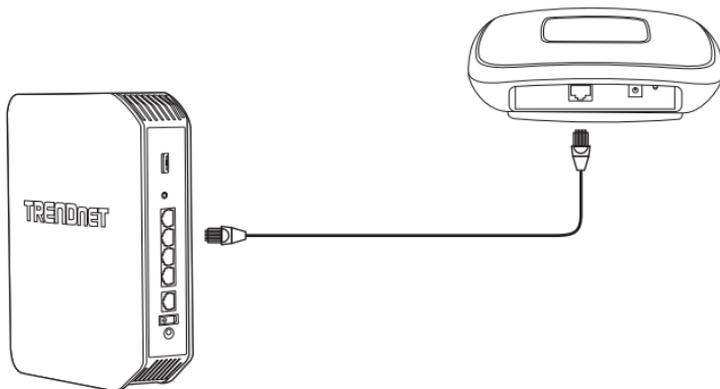
2. Se state collegando il TEW-755AP ad un switch PoE, il dispositivo si accenderà automaticamente. Se lo state collegando ad un computer, oppure ad uno switch non PoE, avrete bisogno dell'alimentatore incluso.
