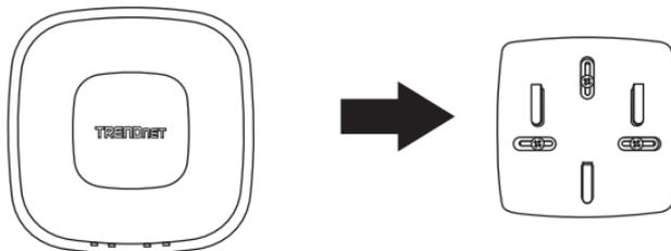
2. Collocare la piastra di montaggio sulla parete o soffitto dove il dispositivo verrà posizionato e segnare l'impronta dei fori per le viti. Assicurarsi che il dispositivo abbia spazio libero a sufficienza per essere estratto dalla piastra di montaggio. Se non si tratta di una installazione PoE, verificare che la posizione di montaggio abbia accesso ad una presa di corrente.
