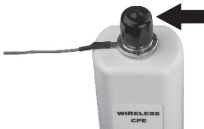
3. Sluit de aardingsdraad aan op een geaard object. e.g. aardaangedreven stang of geaard elektrisch systeem.
