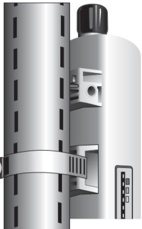
4. Maak de TEW-715APO aan de paal vast door de schroef volgens de wijzers van de klok te draaien.
