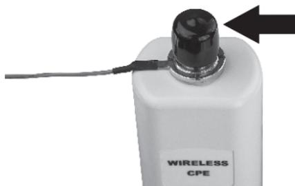
3. Свържете заземителния проводник към заземяващ предмет, напр. заземителен прът или заземена електрическа система.
