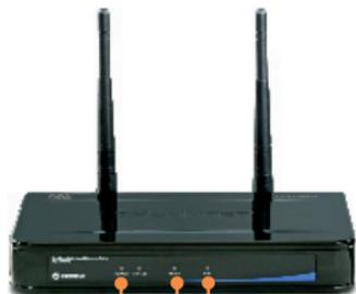
4. Compruebe que las siguientes luces del panel están encendidas: **Power (Encendido), LAN y WLAN**
