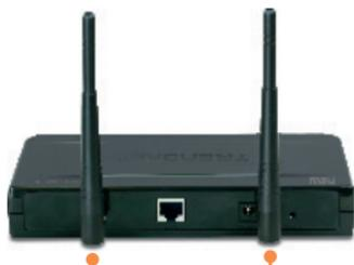
2. Conecte el cable RJ-45 del conmutador/enrutador al puerto LAN del Punto de Acceso.
