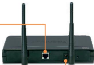
3. Conecte el adaptador de alimentación AC al Punto de Acceso y luego a una toma de corriente.
