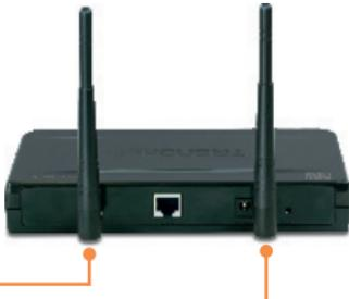
2. Verbinden Sie den Switch/Router über ein RJ-45-Kabel mit dem **LAN-Port** des Access Points.
