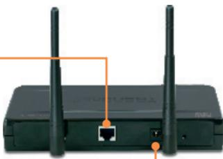
3. Verbinden Sie den Stromadapter mit dem Access Point und stecken Sie ihn in eine Steckdose.
