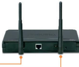
2. Branchez un câble RJ-45 entre le Switch/Routeur et le port **LAN** du point d'accès.
