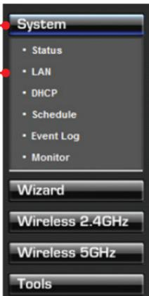
12. Configure las opciones de configuración LAN para que coincidan con las configuraciones de su red y luego haga clic en Apply (Aplicar).
