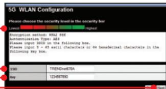
8. Introduzca el SSID deseado y la clave. Luego, haga clic en Next (Siguiente). El SSID predeterminado para 5G WLAN es TRENDnet670A.
