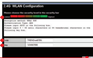
6. Introduzca el SSID deseado y la clave. Luego, haga clic en Next (Siguiente). El SSID predeterminado para 2.4G WLAN es TRENDnet670N.
