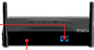
2. Conecte el adaptador de alimentación AC al TEW-670AP y luego a una toma de corriente.
