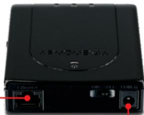
6. Conecte o Adaptador de Tensão AC ao TEW-655BR3G e então a uma tomada elétrica.
