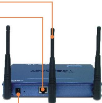
2. Verbinden Sie den Stromadapter mit dem Access Point und stecken Sie ihn in eine Steckdose.
