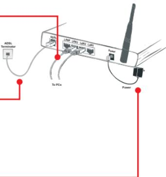
2. Присоедините один конец кабеля RJ-11 к порту ADSL устройства TEW-436BRM. Присоедините другой конец кабеля к телефонному гнезду.
