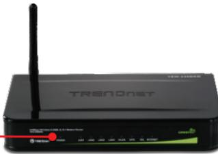
4. Убедитесь в загорании следующих индикаторов на панели: **Power**, **LAN** и **WLAN**. Если индикаторы не светятся, нажмите кнопку **Power ON/OFF** на задней панели устройства TEW-436BRM.
