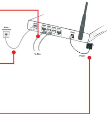
2. Branchez une extrémité du câble RJ-11 au port ADSL du TEW-436BRM. Branchez l'autre extrémité à la prise du téléphone.
