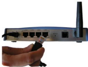
2 -Connectez le câble RJ 45 au routeur à l'emplacement marqué LAN 1 et à la prise Ethernet de la carte réseau de votre ordinateur (prise de même forme que celle du routeur).
