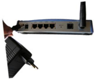
1 -Connectez le bloc d'alimentation au modem/routeur aDSL à l'emplacement marqué Power.
