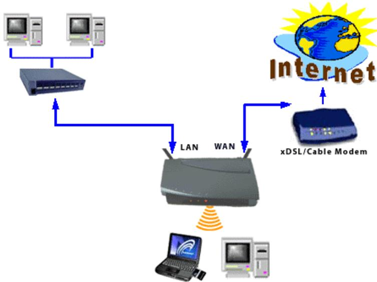
Encienda el equipo. La luz de encendido le indicará que el dispositivo está operando. El usuario puede conectar el modem DSL o el cable modem al puerto WAN del Router para red inalámbrica 802.11g AP. El LED de WAN le indicará que la conexión esta activa.
