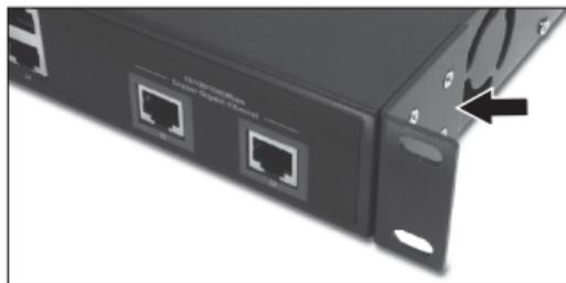
4. Coloque el conmutador con cuidado encima del bastidor. Haga que la abrazadera coincida con los orificios de los tornillos del bastidor, luego use los tornillos suministrados junto con el bastidor del equipo para montar el conmutador.
