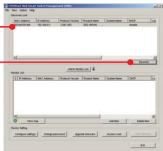
5. Выберите коммутатор **Switch** в списке **Monitor List** и щелкните по параметрам конфигурации - **Configuration setting**.
