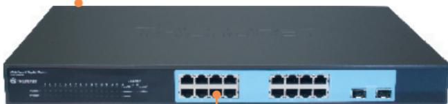
2. Conecte um cabo de rede RJ-45 CAT-5 do computador a uma porta Ethernet disponível no TEG-160WS/TEG-240WS.
