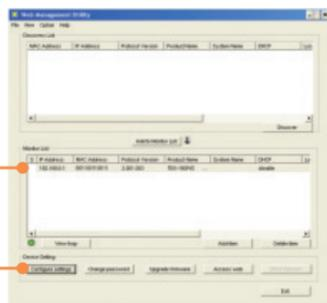
6. Configure o **IP Address** (Endereço IP), **Subnet mask** (Máscara de Rede), **Gateway**, e **Password** (Senha). Clique **Set** (Configurar).
