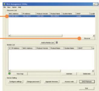
5. Cliquez sur le **Switch** de la liste de contrôle (**Monitor List**) et ensuite sur **Configuration setting** (Paramétrage de la configuration).
