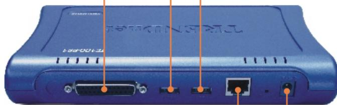
2. Подключите кабель RJ45 к порту ЛС и сетевому концентратору.
