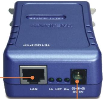
2. Verbinden Sie das **Netzteil** mit dem Druckserver und stecken Sie es in eine Steckdose.
