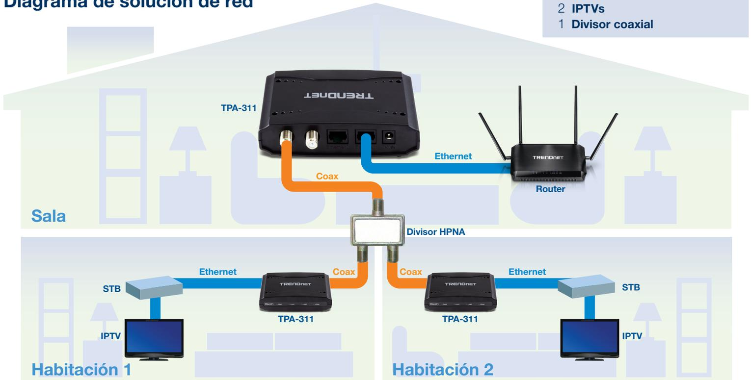
Este diagrama ilustra la instalación de adaptadores TPA-311 para crear una conexión Ethernet rápida utilizando el cableado coaxial existente en una casa para streaming por IPTV.
