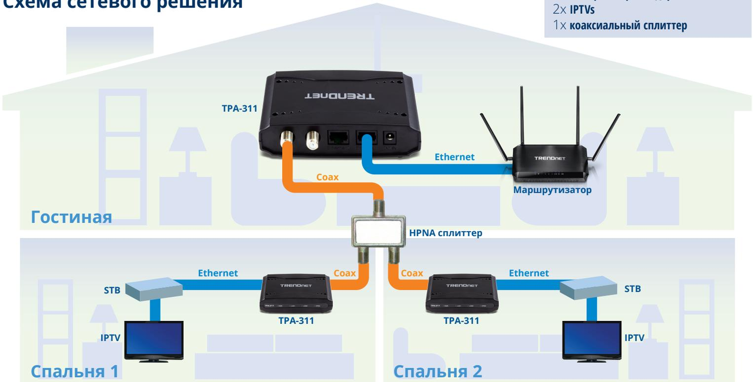
Эта схема показывает установку адаптеров TPA-311 для создания скоростного соединения Ethernet с использованием уже существующих в доме коаксиальных кабелей для потока IPTV.
