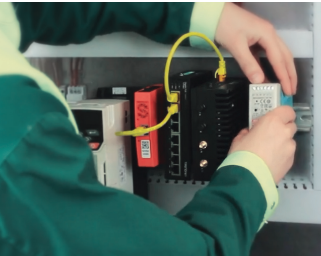
Installation des industriellen Switches TI-PG80 von TRENDnet auf DIN-Schiene.
