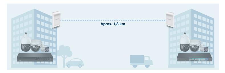
Uma aplicação comum para conexão sem fio é o uso em vigilância, onde o cabeamento não é uma opção. A instalação pode ocorrer entre dois edifícios diferentes ou de um edifício para um poste em um estacionamento. As soluções de bridge sem fio são especialmente úteis para projetos em locais remotos.
