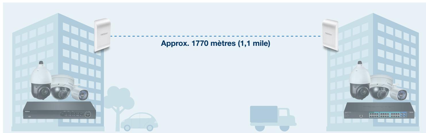
Les applications de surveillance sont une utilisation courante du pontage WiFi, lorsque le câblage n'est pas envisageable. L'installation peut avoir lieu entre deux bâtiments différents ou entre un bâtiment et un poteau dans un parking. Les solutions de pont WiFi sont particulièrement utiles pour les projets dans des endroits éloignés.
