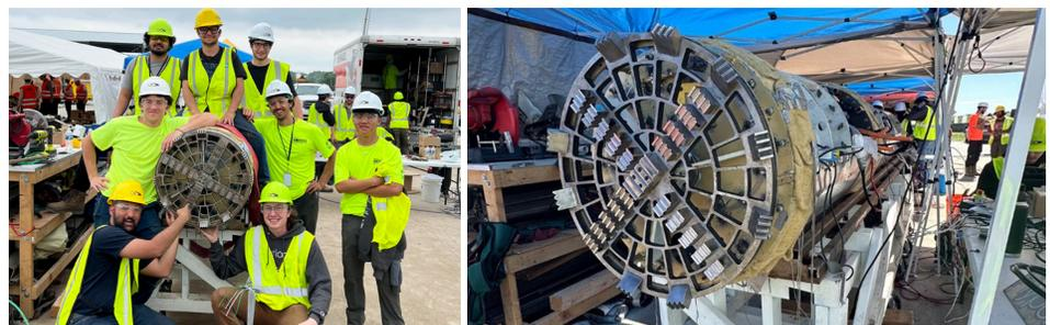
Los microcontroladores y microchips de la tuneladora (TBM) de CU Hyperloop controlan y mueven varias partes de la máquina, como el empuje, el control de la temperatura y el giro del cabezal de corte. El equipo de CU Hyperloop necesitaba una solución robusta que permitiera a los microcontroladores conectarse en red y comunicarse entre sí a lo largo de la tuneladora, todo ello soportando vibraciones, escombros y demás.
