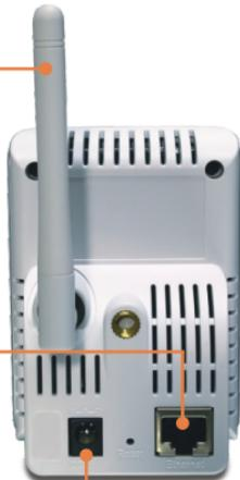
2. Conecte el cable de red RJ-45 del comutador/enrutador al puerto **Ethernet** de la Cámara de Internet.
