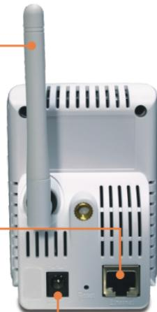
2. Branchez un câble réseau RJ-45 depuis un Switch/Routeur vers le port **Ethernet** de la Webcam.
