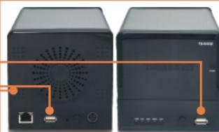
**6.** Присоедините кабель RJ-45 от коммутатора/концентратора к гнезду LAN устройства TS-S402.
