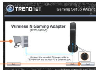
6. Branchez l'adaptateur AC au point d'accès et à une prise de courant et cliquez sur **"Next"** (Suivant).
